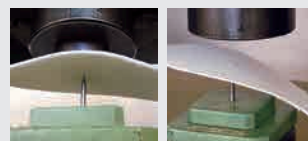
踏抜き性能試験
